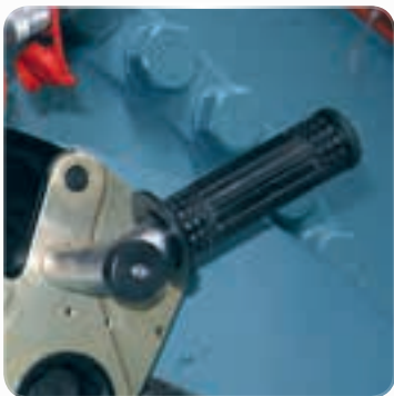
Рукоятка удержания и перемещения гайковерта входит в объем поставки
