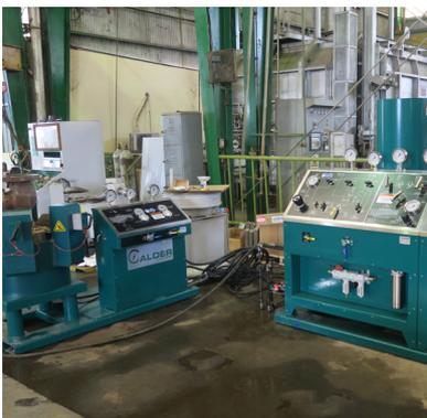
**SRV | ПРИБОРЫ СОВМЕЩЕННОГО ИСПЫТАНИЯ РЕГУЛИРУЮЩИХ КЛАПАНОВ**
