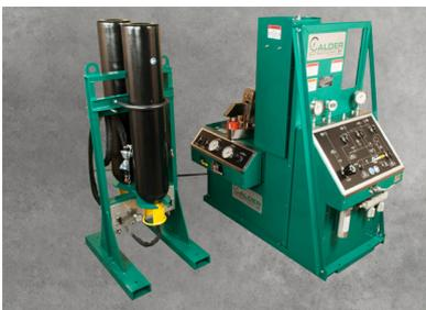
**Прибор испытания предохранительно-перепускного клапана (SRV)**
