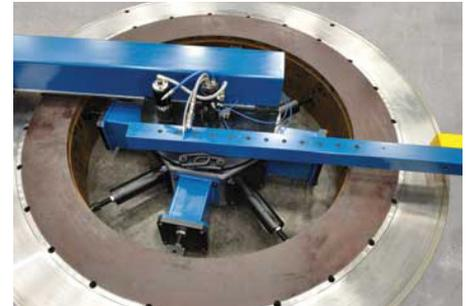
Станок для обработки фланцев, **FF8200**
