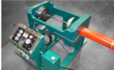
Универсальная система для тестирования прямых проходных клапанов **USV HYDROPRO™**
