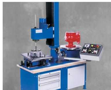
Стационарный станок для ремонта запорных клапанов и шаровых затвижек **VM5800**
