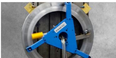
Станок для обработки фланцев **FF6300**
