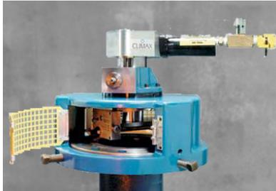
Станок для обработки фланцев **FF1000**
