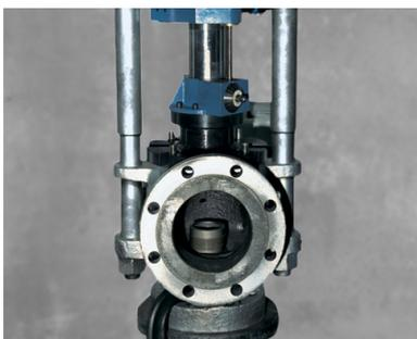
Станок для ремонта предохранительных клапанов **VM7000**
