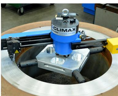
Станок для обработки фланцев, **FF5300**
