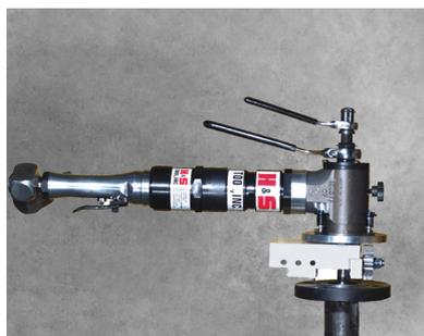
Станок для обработки фланцев, **МОДЕЛЬ BF**
