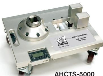
Предназначен для испытаний инструментов с непрерывно вращающимися выходными шпинделями. Испытательный стенд включает в себя зажимное приспособление, втулку для фиксации боковой нагрузки, реакционную штангу или реакционные лопатки, датчик и дисплей анализатора крутящего момента.
