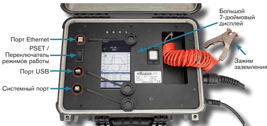
Контроллер для использования в полевых условиях iEC4WF
