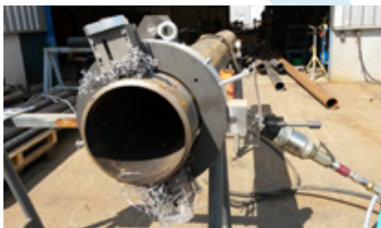
TT273 Станок для резки и снятия фасок с пневматическим приводом
