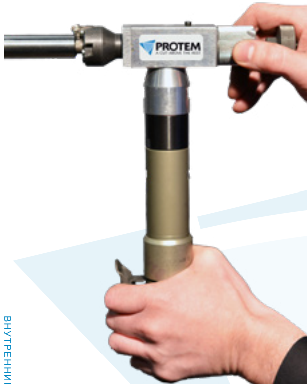
SM8 с пневматическим приводом
