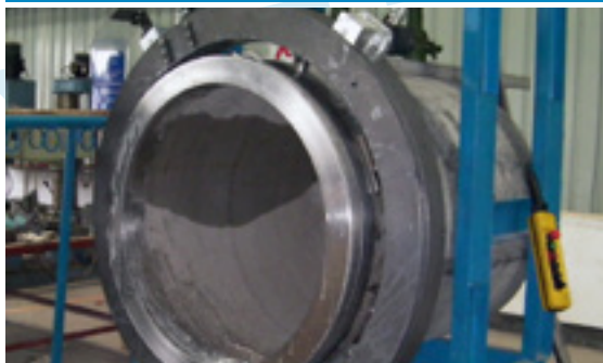
TT1016 Станок для резки и снятия фасок с пневматическим приводом
