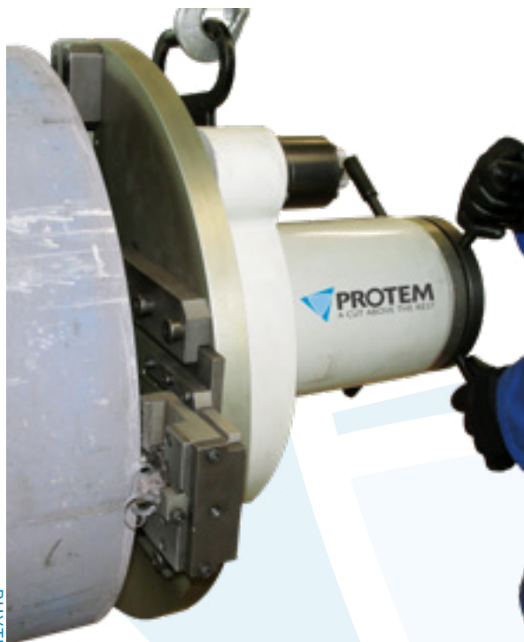
US150 с пневматическим приводом
