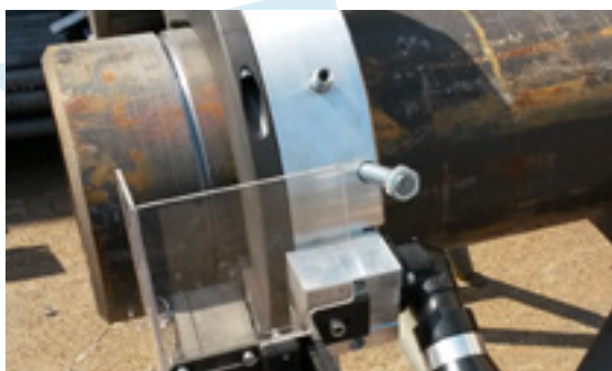
TT219 Станок для резки и снятия фасок с пневматическим приводом
