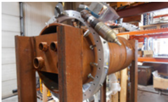
TT900 Станок для резки и снятия фасок с пневматическим приводом
