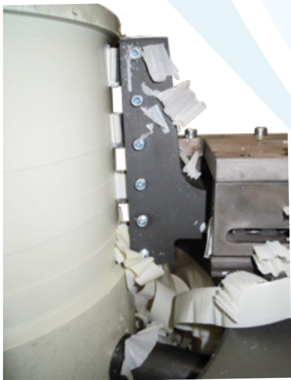
PROTEM TT-NG Станки для орбитальной резки труб с опцией удаления покрытия
