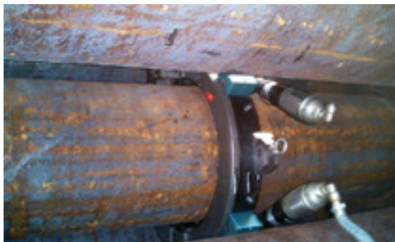
TTLW168 Станок для резки труб и снятия фаски с пневматическим приводом
