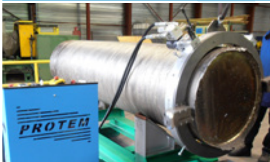
TT610 Станок для резки и снятия фасок с пневматическим приводом
