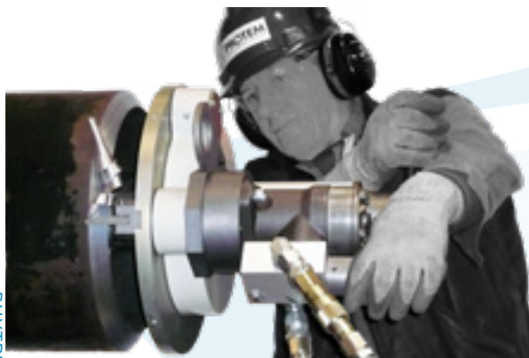
US80 с пневматическим приводом
