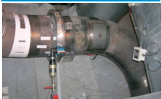
TTLW508 для резки труб и снятия фаски с пневматическим приводом
