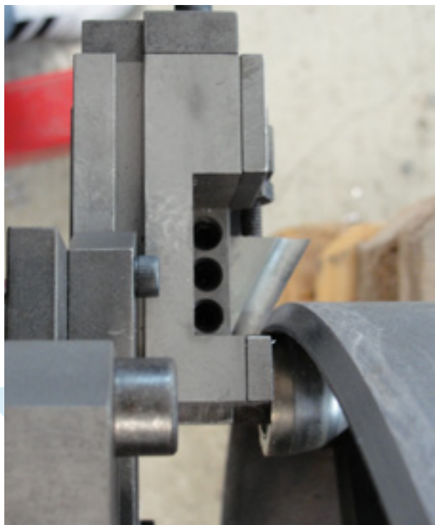
Устройство для обработки по контуру внутреннего диаметра (ID-Tracker или IDT) для станков серии US PROTEM
