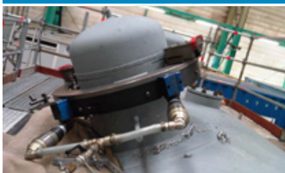
TT508 Станок для резки и снятия фасок с пневматическим приводом
