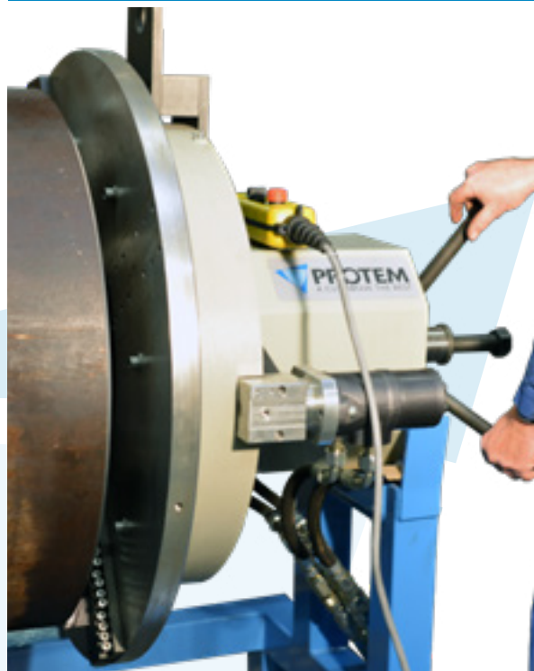
US450 с гидравлическим приводом
