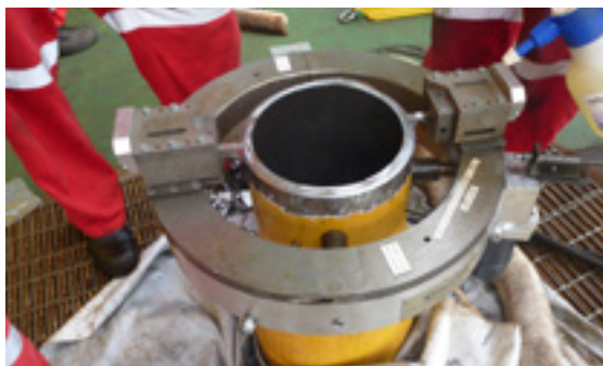
TT406 Станок для резки и снятия фасок с пневматическим приводом
