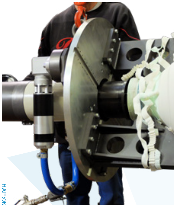
Станки PROTEM модели US с функцией удаления покрытий
