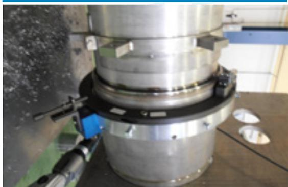
TTLW508 для резки труб и снятия фаски с пневматическим приводом
