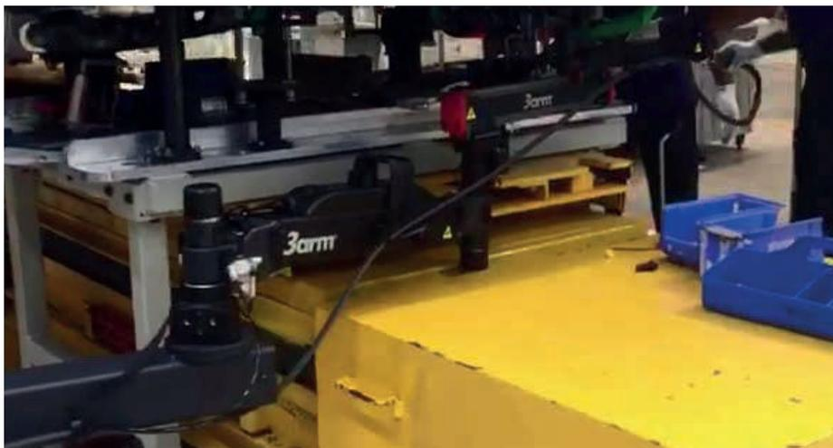
Расширенный горизонтальный охват охватывает более 2 м.
