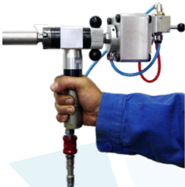
S18 CA с автоматическим пневматическим прижимным механизмом
